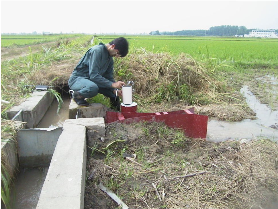
شکل ۵- پارشال فلوم نصب شده در ورودی کرت شالیزاری
