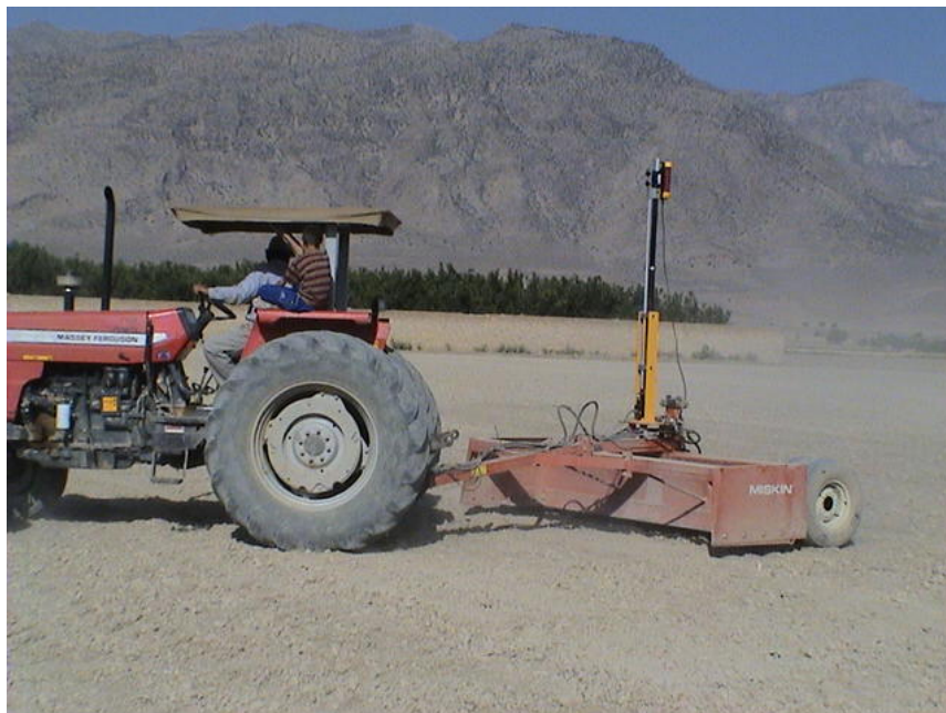
نگاره ۷- واحد تسطیح لولر لیزری مسکین ساخت کشور آمریکا در حین اجرای عملیات تسطیح در منطقه سروستان.
