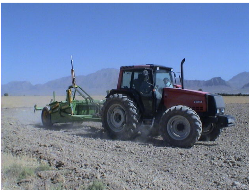
نگاره ۸- واحد تسطیح اسکریپر لیزری ساخت کشور استرالیا در حین اجرای عملیات تسطیح در منطقه سروستان.
