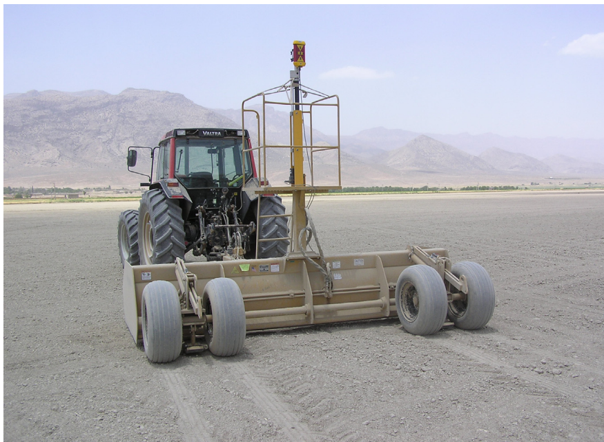
نگاره ۱- یک واحد تسطیح لولر لیزری مدل رینولدز ساخت کشور امریکا.
