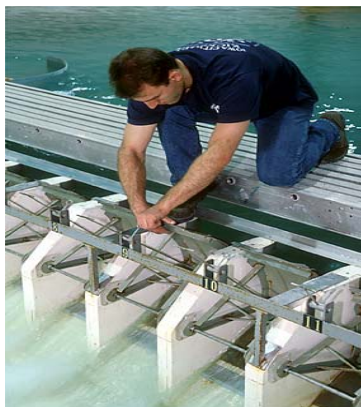
شکل ۵- مدل فیزیکی سرریز یک سد
