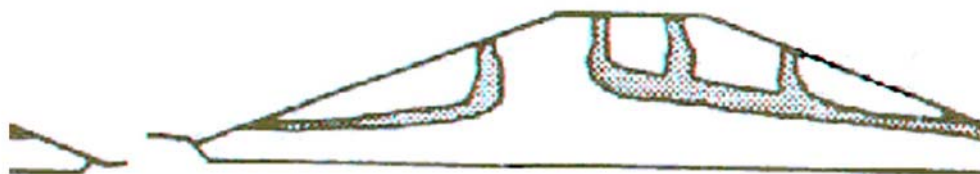
شکل (۳) - آب شستگیهای داخلی در بدنه یک خاکریز رسی واگرا [۹].
