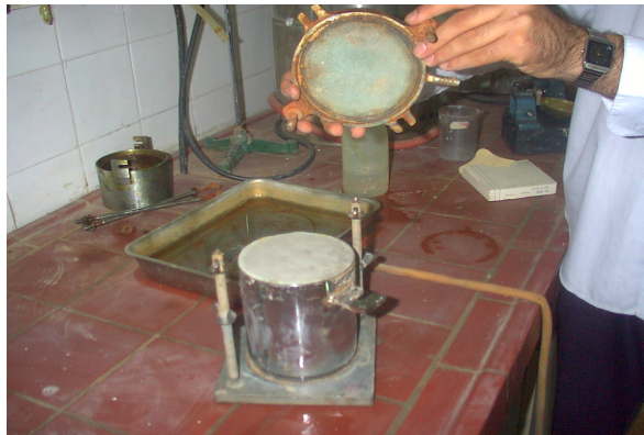
شکل (۵) : بستن انتهای نمونه با صفحه متخلخل
