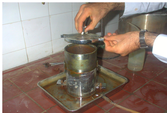
شکل (۷) : نصب کردن قسمت‌های مختلف دستگاه آزمایش بار افتان
