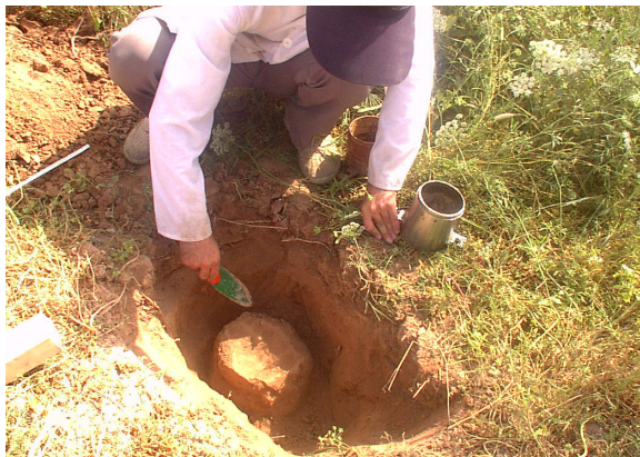
شکل (۲): ایجاد استوانه ای از خاک جهت نمونه برداری بهتر
