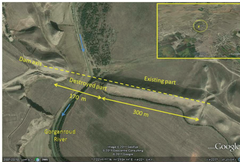
Fig. 4. The location of Garkaz dam and features (la localit  et les caract ristiques de la digue Garkaz)
