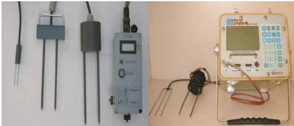
شکل ۹: دستگاه انعکاس سنجی حوزه زمانی (TDR) شامل انواع پراب و دستگاه اندازه‌گیری
