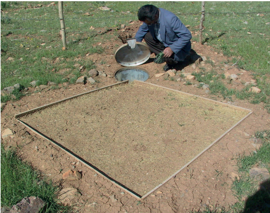
Fig. 4. The compacted soil with straw mulch and its tank (down ward)( Le sol compacté avec paille et il est le réservoir)
