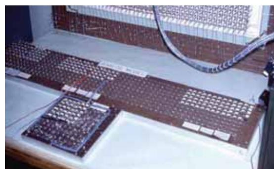
شکل ۶ - مجموعه‌ای از خازن و مقاومت الکتریکی که هیدرولیک جریان آب زیرزمینی را در یک آبخوان بوسیله مدل قیاسی نشان می‌دهد
