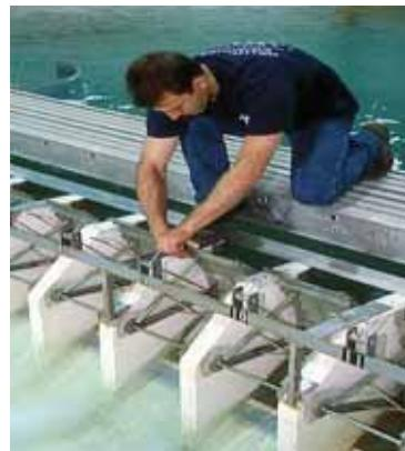
شکل ۵- مدل فیزیکی سرریز یک سد
