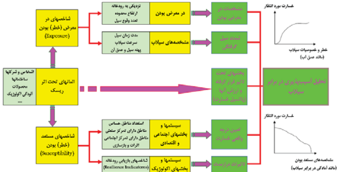
شکل (۲)- روند نمای تحلیل آسیب پذیری در برابر سیلاب
