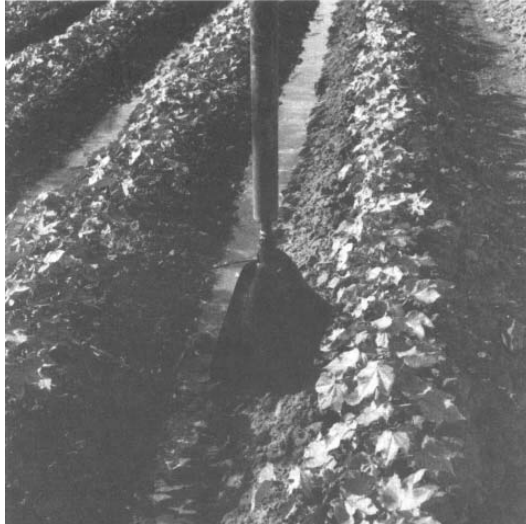
شکل ۵-۱۰. یک نمونه سیستم بارانی خطی مجهز به آفشان‌های LEPA
