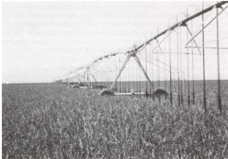
شکل ۵-۱۱. یک نمونه سیستم بارانی خطی مجهز به آفشان‌های LEPA در مزرعه پیاز
