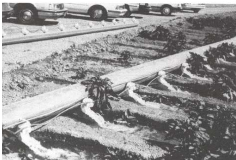
شکل ۳-۹. یک سیستم آزمایشی جریان موجی همراه با شیرهای مجزا برای هر شیار. (چنین طرح‌هایی به سبب پیچیدگی و هزینه بالا، دیگر مورد استفاده قرار نمی‌گیرند).
