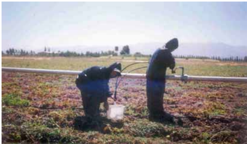
شکل (۲) - اندازه‌گیری دبی آبیاش به کمک یک قطعه شیلنگ و سطل مدرج و کورنومتر
