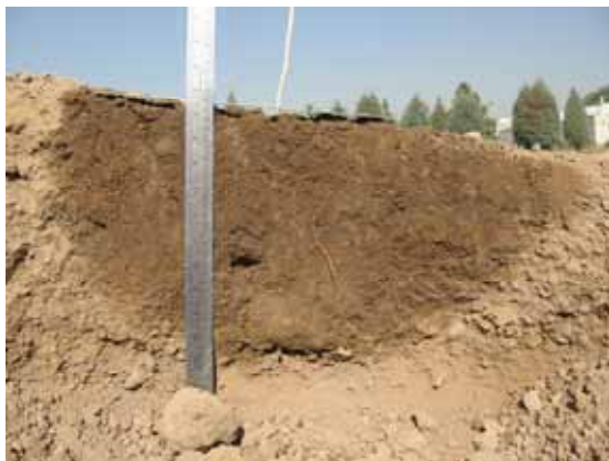
شکل (۱۲) - انحراف محور پیاز رطوبتی از محور قطره چکان در زمین شیب دار
