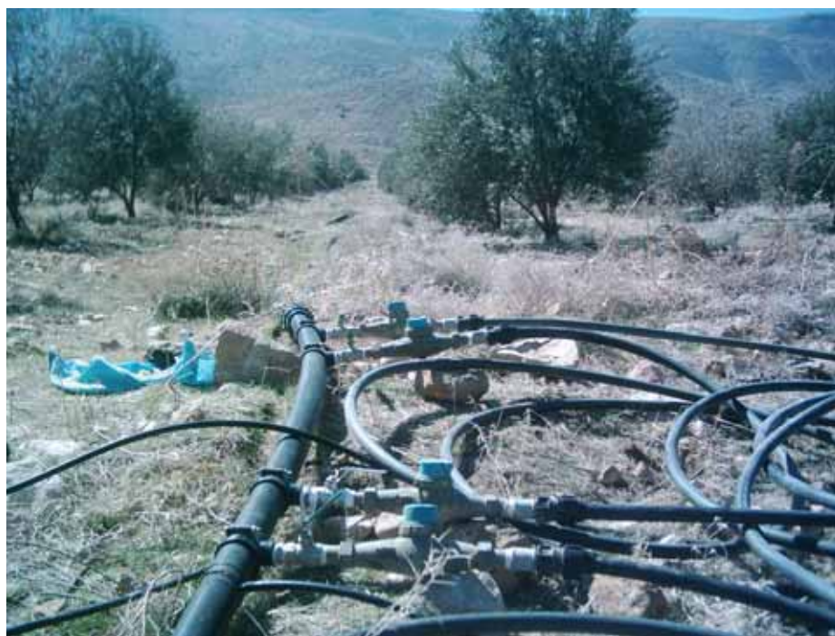
شکل (۱) - محل انجام تحقیق و کنتورهای نصب شده جهت اندازه گیری آب
