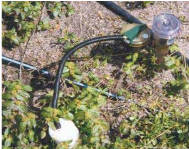
شکل (۶) - سنسور رطوبتی که بوسیله تانسومتر رطوبت اندازه گیری شده و آبیاری کنترل می شود.
