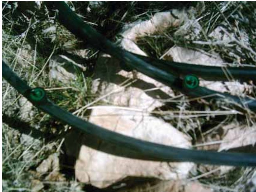
شکل (۲) - نمونه ای از قطره چکان فشار شکن مورد استفاده در طرح
