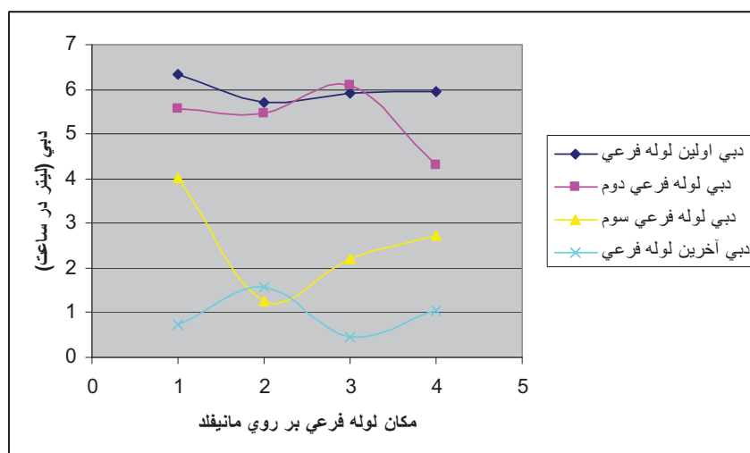
شکل (۷) - تغییرات دبی قطره چکانهای واقع بر لوله های فرعی مانیفولد سیستم G
