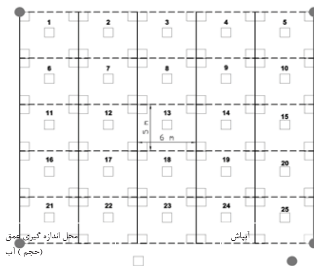
شکل (۲) - ارائه شماتیکی شبکه اندازه گیری آب آبیاری در یک پلات آزمایشی
