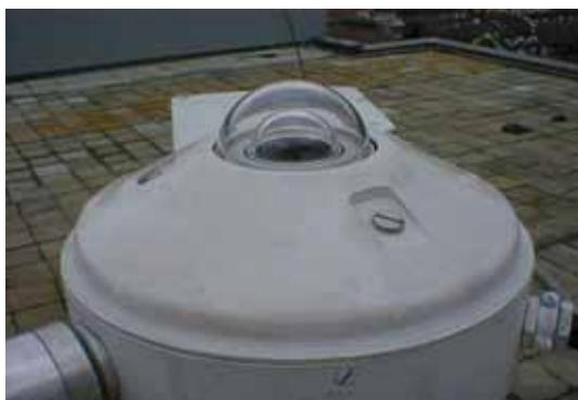
شکل ۳: نمونه‌ای از حسگر اندازه‌گیری نور
